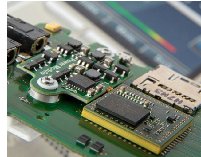
Module ermöglichen Lagenreduktion der Leiterplatte
